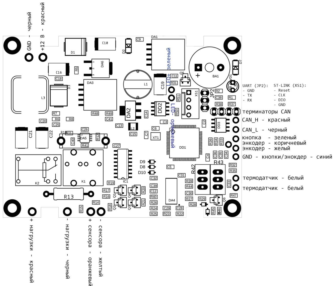
Рисунок 5 Схема выводов контроллера КДС-2 Мини ревизии 2.2
