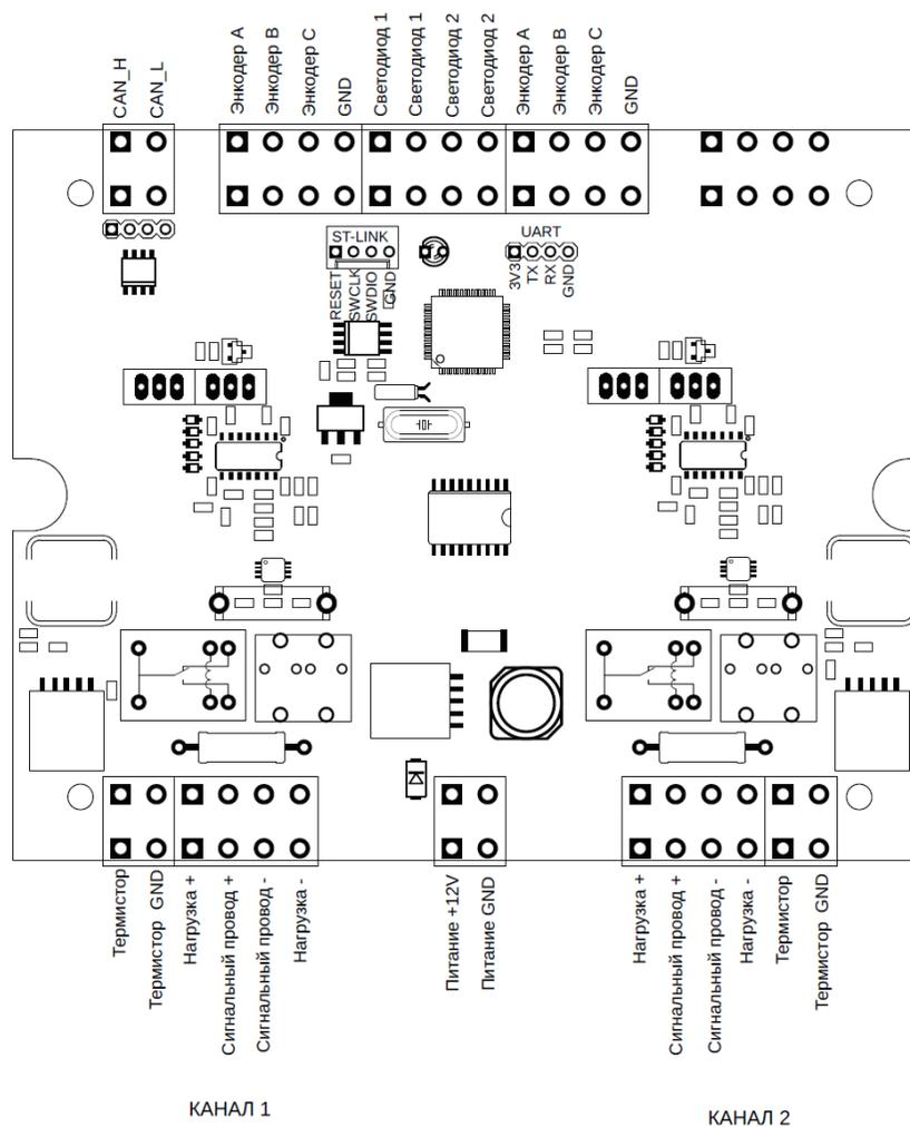
Рисунок 3. Схема выводов контроллера КДС-2
