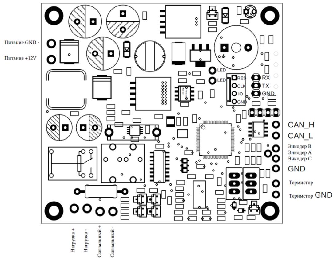
Рисунок 4. Схема выводов контроллера КДС-2 Мини ревизии 2.1
